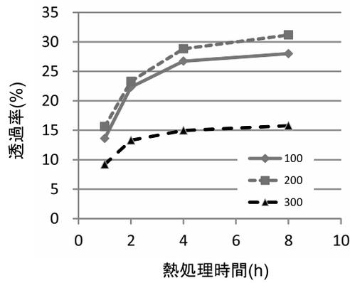
図 2: 熱処理条件による透過率の変化
